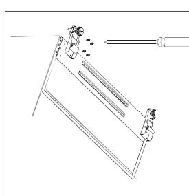
6. Une fois l'appareil installé, remontez les portes en suivant les étapes citées ci-dessus dans l'ordre inverse.
