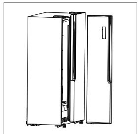
5. Schroef de onderste scharnieren los.
