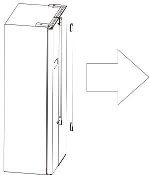
3. Nadat het apparaat op zijn definitieve plaats is gezet, kunt u de deurgrepen weer terug monteren door het bovenstaande proces in de omgekeerde volgorde uit te voeren.
