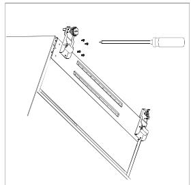
6. Nadat het apparaat is geplaatst, installeert u de deuren weer door het hierboven uitgevoerde proces in de omgekeerde volgorde uit te voeren.
