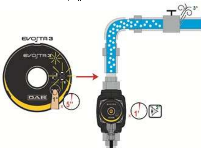
Figura 9: Drenagem automática da bomba
