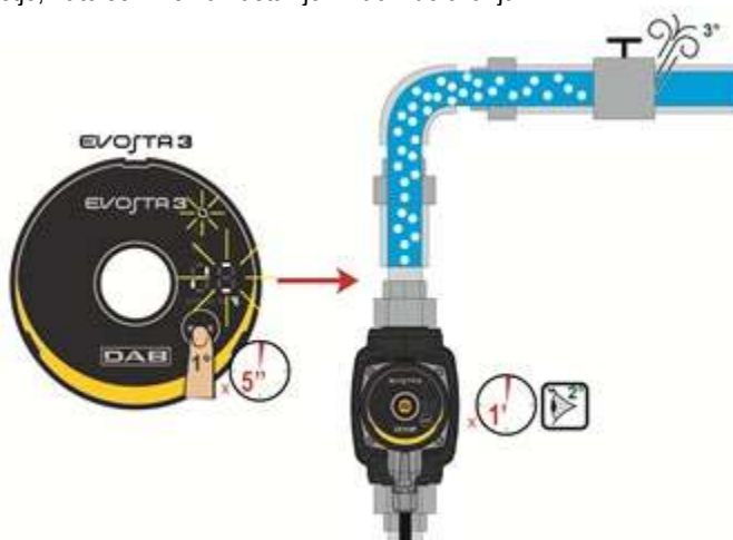
Slika 9: Avtomatska odzračitev črpalke
