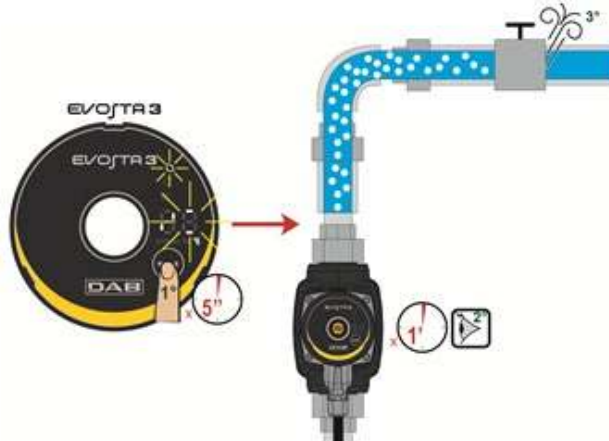
Εικόνα 9: Αυτόματη εξαέρωση της αντλίας
