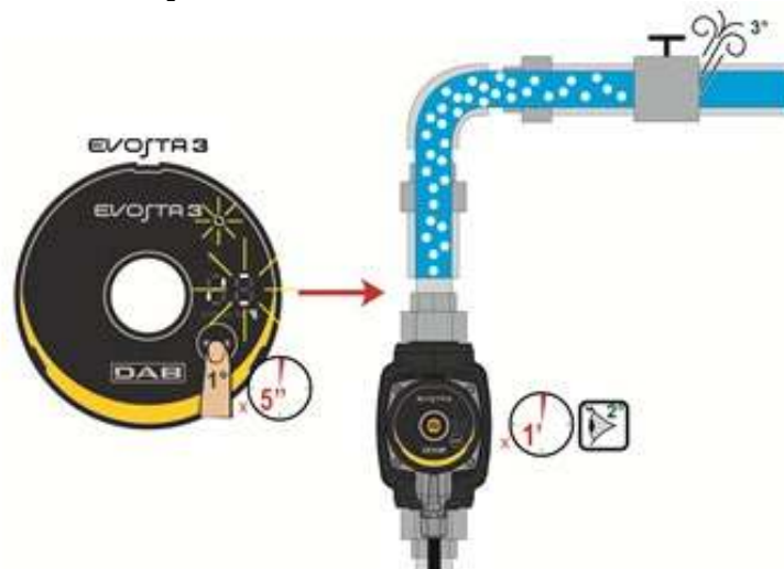
Fig 9: Automatisk avluftning av pumpen
