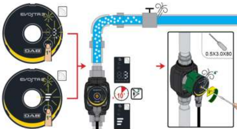
8 pav.: Oro išleidimas iš siurblio
