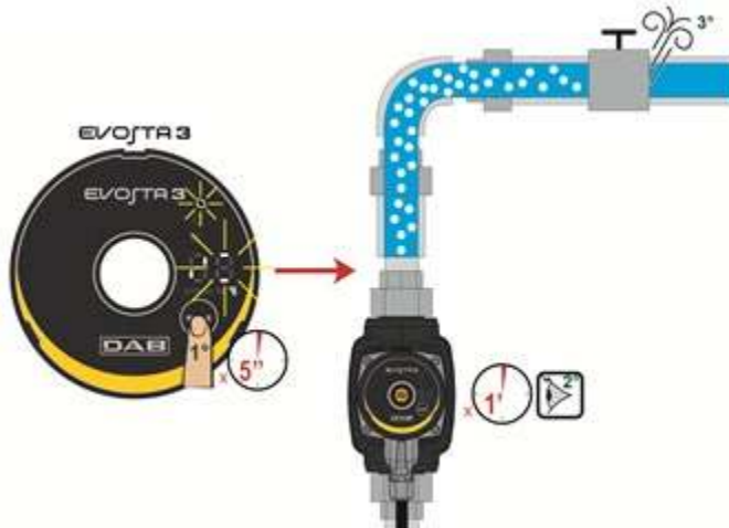
Фигура 9: Автоматично обезвъздушаване на помпата
