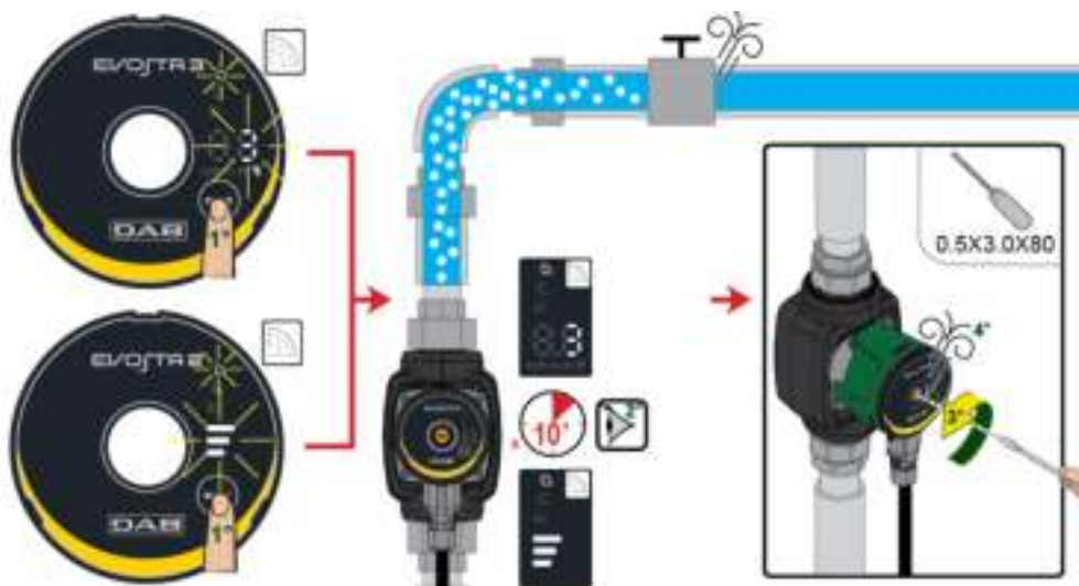
Рисунок 8: Удаление воздуха из насоса
