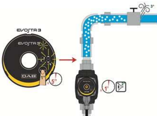
Attēls 9: Sūkņa automātiska gaisa izvadīšana
