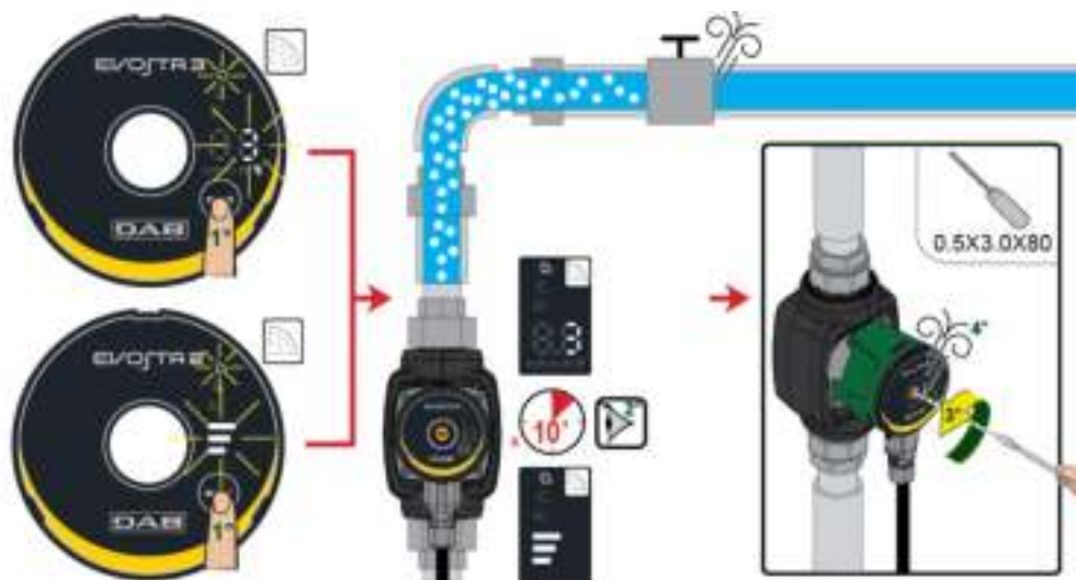
Figura 8: Drenagem da bomba
