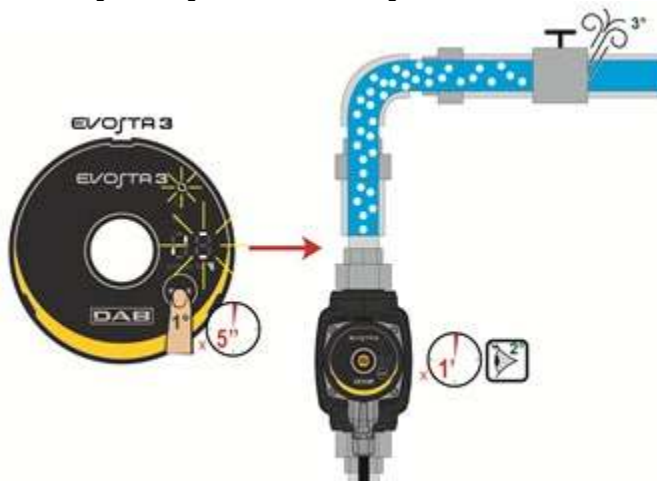
Afbeelding 9: Automatische ontluchting van de pomp
