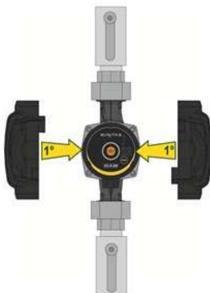
Фигура 7: Изолация на корпуса на помпата
