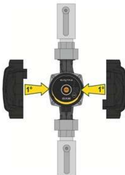
Figura 7: Isolamento do corpo da bomba
