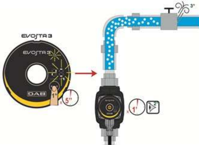
Малюнок 9: Автоматичний випуск газів з насоса
