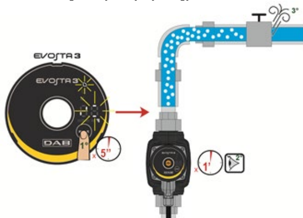
9. ábra: A pumpa automatikus légmentesítése
