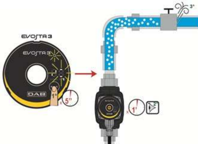
9 pav.: Automatinis oro išleidimas iš siurblio
