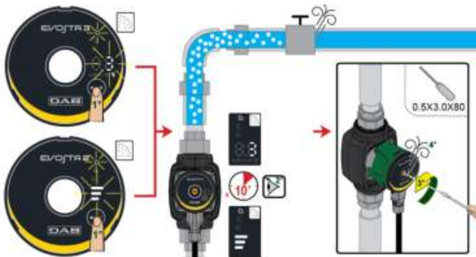
Figura 8: Sfiato della pompa
