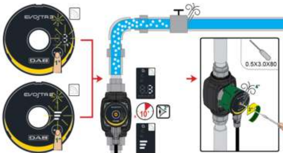
Afbeelding 8: Ontluchting van de pomp
