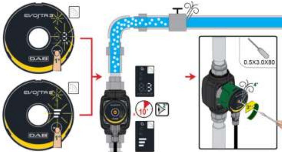
Fig 8: Avluftning av pumpen
