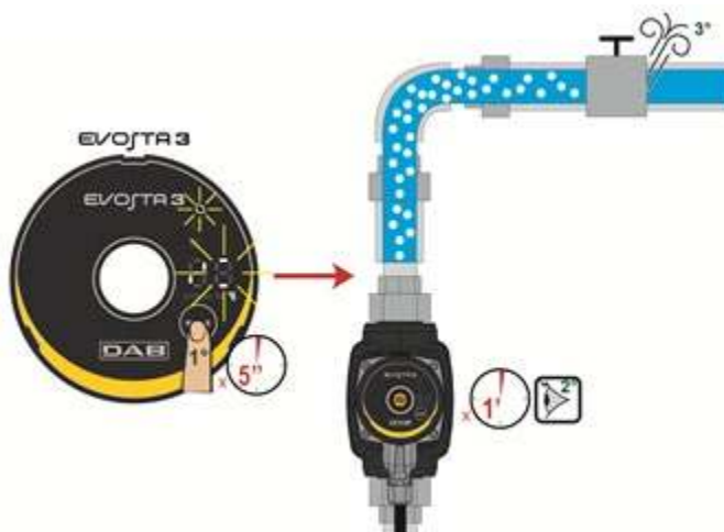
Obrázok 9: Automatické odvzdušnenie čerpadla
