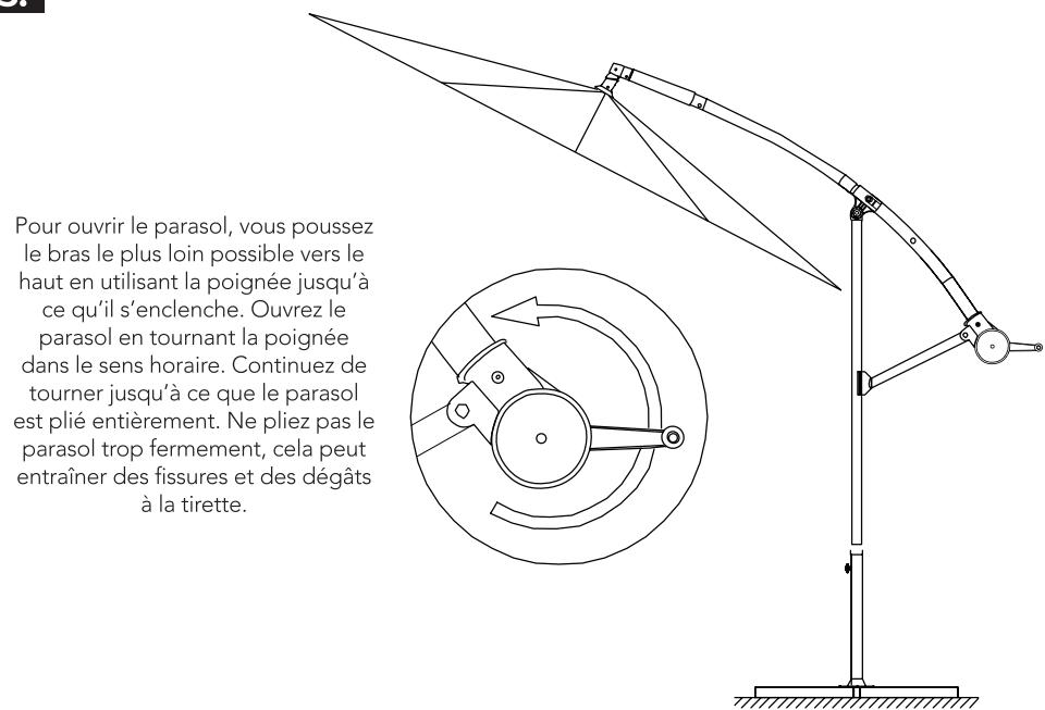
Pour ouvrir le parasol, vous poussez le bras le plus loin possible vers le haut en utilisant la poignée jusqu'à ce qu'il s'enclenche. Ouvrez le parasol en tournant la poignée dans le sens horaire. Continuez de tourner jusqu'à ce que le parasol est plié entièrement. Ne pliez pas le parasol trop fermement, cela peut entraîner des fissures et des dégâts à la tirette.
