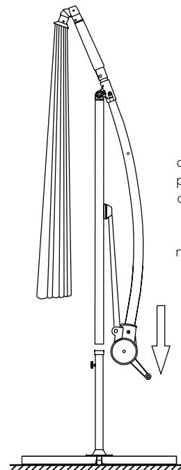
Plaats de parasol in de onderste stang. Draai de parasol totdat de pinnen op de stang op hun plek schieten. Bevestig de parasol aan de stang met behulp van de borgschroeven.
