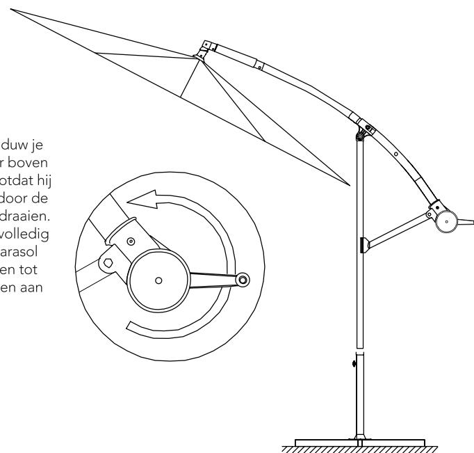
Om de parasol te openen duw je de arm zo ver mogelijk naar boven met behulp van de slinger totdat hij vastklikt. Open de parasol door de slinger met de klok mee te draaien. Blijf draaien tot de parasol volledig uitgefouwd is. Trek de parasol niet te ver uit, dit kan leiden tot scheuren en beschadigingen aan het trektouw.
