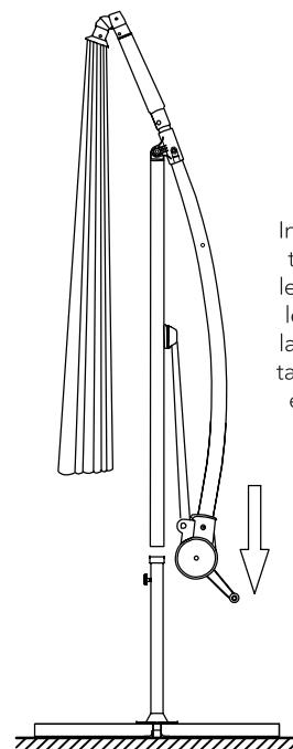
Insérez le parasol dans la tige inférieure. Tournez le parasol jusqu'à ce que les goupilles situées sur la tige s'enclenchent. Attachez le parasol à la tige en utilisant les boulons de fixation.
