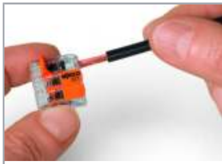
Geleider aansluiten: klempositie met de bedieningshendel openen en de geleider invoeren.
