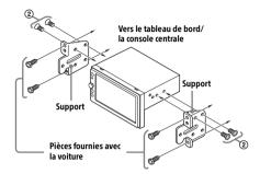
Si vous installez cet appareil sur les supports préinstallés de votre véhicule, faites passer les vis fournies (2) par les trous de vis appropriés, en fonction de votre véhicule :
