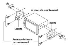
Al montar esta unidad en los soportes preinstalados de su automóvil, use los tornillos ② suministrados en los espacios para tornillos correspondientes según su automóvil: T para TOYOTA y N para NISSAN.
