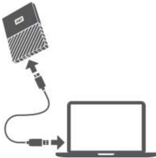
Afbeelding 3: Aansluiten van de My Passport-schijf
