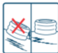
Un emplacement de niveau
