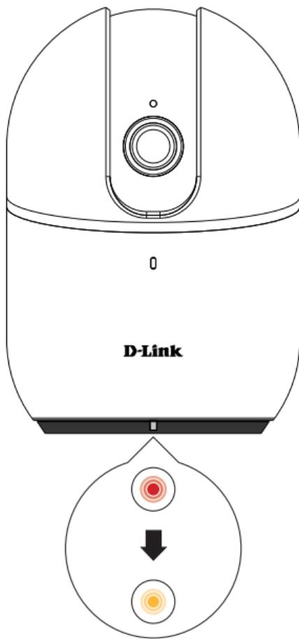
Une fois que la caméra sous tension, elle pivote à gauche, à droite et à gauche pour se calibrer. Patientez jusqu'à ce que la LED située à l'avant passe du rouge à l'orange clignotant.
