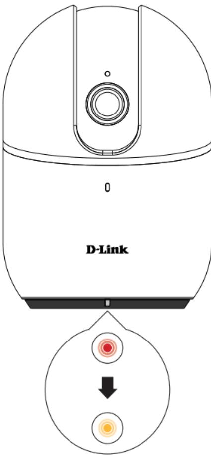
Po włączeniu kamera wykona obrót w prawo i w lewo oraz w górę i w dół w celu kalibracji. Poczekaj aż dioda LED z przodu zmieni światło z czerwonego na migające pomarańczowe.
