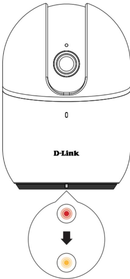
Dopo l'accensione, la telecamera ruoterà a destra e a sinistra e in alto e in basso per la calibrazione. Attendere fino a quando il LED sulla parte anteriore cambia da rosso ad arancione lampeggiante.
