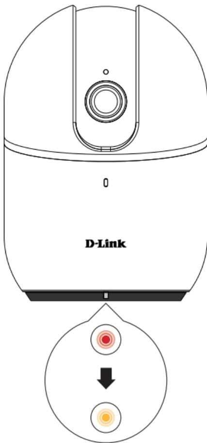
Depois de ligada, a câmara roda para a esquerda e para a direita, para cima e para baixo, para se auto-calibrar. Aguarde até que o LED (na frente) mude de vermelho para laranja intermitente.
