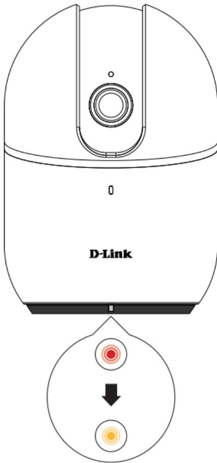
Zodra de camera is ingeschakeld, zal hij naar links, rechts, boven en onder draaien om zich te calibreren. Wacht tot het ledlampje aan de voorkant van rood naar oranje knippert.
