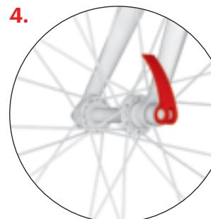
Затяните настроечную гайку эксцентрика так, чтобы перед закрытием рычажка эксцентрика вы почувствовали значительное сопротивление. Рычажок закройте в таком положении, чтобы он не прикасался к вилке, и в то же время чтобы исключить его случайное открытие во время езды.
