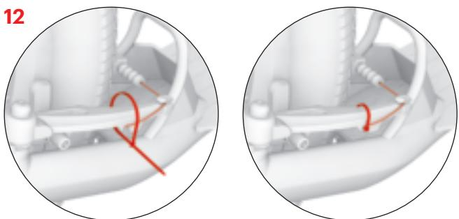
Koniec brzdového lanka zafixujte do zámku a zabezpečte stahovacou páskou, pásku potom zastríhnite (platí pre prednú aj zadnú brzdu).
