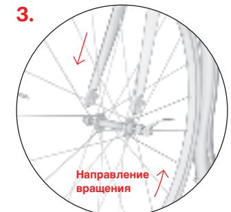
Колесо вставьте в переднюю вилку так, чтобы оно было точно посередине. **Внимание:** Рисунок протектора шины должен быть направлен вперед (на некоторых шинах см. стрелку направления сбоку).
