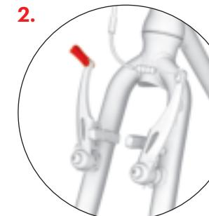
Сначала проверьте, повернута ли передняя вилка в правильном направлении (рычаги ободного тормоза находятся спереди), затем ослабьте плечи тормоза, повернув рычажок.
