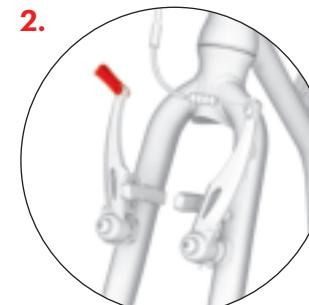
Nejprve zkontrolujte, zda je přední vidlice koloběžky natočená ve správném směru (ramena V-brzdy směřují dopředu), pak uvolněte brzdové čelisti pootočením páčky.
