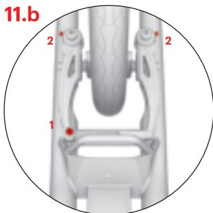
Zkontrolujte, zda se špalíky při uvolnění brzdové páčky dostatečně oddálí od ráfku (1-2 mm). Vzdálenost špalíků lze upravit přitažením či povolením brzdového lanka v kotevním šroubu (1). Pokud kolo při otáčení v některém místě škráb o brzdový špalík, symetricky upravte vzdálenost brzdových ramen napínacími šroubkami (2).
