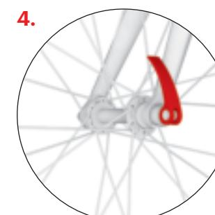
Dotiahnite nastavovaciu maticu rýchlopínača tak, aby ste tesne pred dovetím rýchlopínačej páčky cítili značný odpor. Páčku zavrite v takej pozícii, aby sa nedotýkala vidlice a zároveň nemohlo dôjsť k jej náhodnému otvoreniu počas jazdy.
