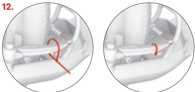
Konec brzdového lanka zafixujte do zámku a zabezpečte stahovací páskou, pásku poté zastrihněte (platí pro přední i zadní brzdu).
