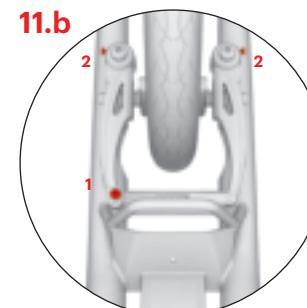
Skontrolujte, či sa špalky pri uvoľnení brzdovej páčky dostatočne oddialia od ráfika (1-2 mm). Vzdialenosť špaliek možno upraviť pritiahnutím alebo povolením brzdového lanka v kotevnej skrutke (1). Ak sa koleso pri otáčaní v niektorom mieste triе o brzdový špalok, symetricky upravte vzdialenosť brzdových ramien napínaním skrutkami (2).
