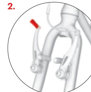
Bringen Sie die Vordergabel des Tretrollers so in Position, dass die Arme der V-Bremse nach vorne gerichtet sind, dann öffnen Sie die Bremsarme durch Drehen des Hebels.
