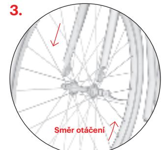
Kolo vsaďte do přední vidlice tak, aby bylo přesně uprostřed. **Pozor:** Vzorek pneumatiky by měl směrovat dopředu po směru jízdy (na některých pneumatikách viz směrová šipka na boku).
