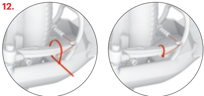
Закрепите конец троса тормоза в замке и закрепите его затяжным хомутом, затем отрежьте лишний конец (относится как к передним, так и к задним тормозам).
