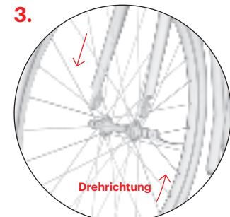
Führen Sie die Radachse in die Schlitze der vorderen Gabel so, dass es in der Mitte ist. **Achtung:** Das Reifenprofil soll nach vorn ausgerichtet sein (bei einigen Reifen siehe Pfeil an der Seite).
