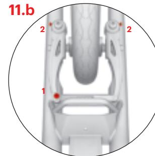
Überprüfen Sie, dass der Abstand der Bremsbeläge von der Felge bei unbetätigtem Bremshebel etwa 1-2 mm beträgt. Dieser Abstand lässt sich durch das Anziehen oder Lockern des Bremsseils in der Fixierschraube (1) regulieren. Falls der Reifen beim Drehen an irgendeiner Stelle den Bremsbelag streift, stellen Sie die Entfernung der Bremsarme durch die Spannschrauben (2) symmetrisch ein.
