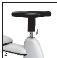
Figura 2: Instale el volante (pieza 2) en el orificio del cuadro (pieza 1).
