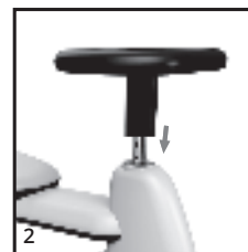
Abbildung 2: Lenkrad (Teil 2) in das Loch der Karosserie einbauen (Teil 1).
