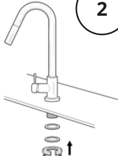
**NL)** Bevestig de koude en warme slang met de hand aan de kraan. Trek de slangen door het montagegat in de aangegeven richting.
