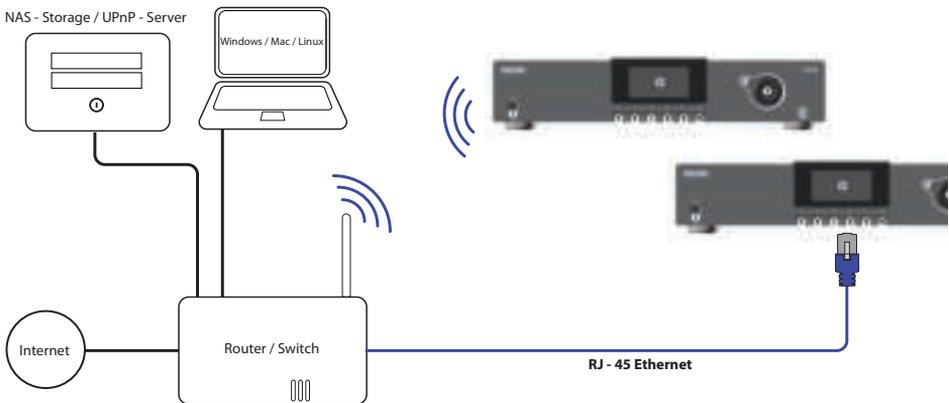
Hier beispielhaft die Einbindung via Kabel oder WLAN
