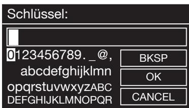
Das Passwort für Ihren WLAN-Router geben Sie über das Navigationsrad ein: Durch Drehen wählen Sie die Buchstaben und Zahlen aus, durch einen Druck auf das Rad bestätigen Sie die Eingabe. Die Sonderzeichen finden Sie, wenn Sie mit dem Rad weiter durchscrollen.
