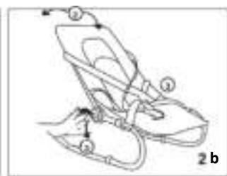
Cuando alcance la posición deseada empuje hacia delante las palancas, hasta la posición vertical, para fijar el respaldo (2b).
