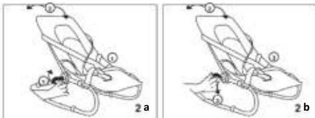
Wenn die Rückenlehne die gewünschte Position erreicht hat, ziehen sie die Hebel nach vorne, bis maximal vertikale Position, um die Rückenlehne zu fixieren (2b).
