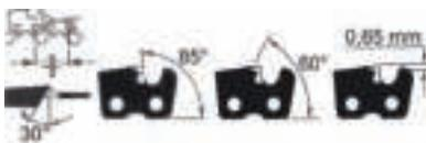
**! Abweichungen von den Maßangaben der Schneidengeometrie können zu einer Erhöhung der Rückschlagneigung der Maschine führen. Erhöhte Unfallgefahr!**
