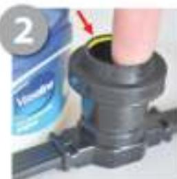
Breng met behulp van je vinger een klein beetje Vaseline aan op het bovenste gedeelte van de binnenkant van de afdichtring (Het gele gemaakteerde gedeelte op de afbeelding). Dit maakt het indraaien van de lamp eenvoudiger.
