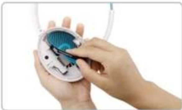
4. PLAATS HET STOFNET IN DE OORSCHHELP
