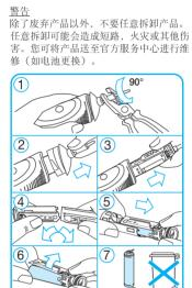
注意!打开手柄将毁坏产品且不再享有保 在移出电池前, 请确认电力已完全耗尽
