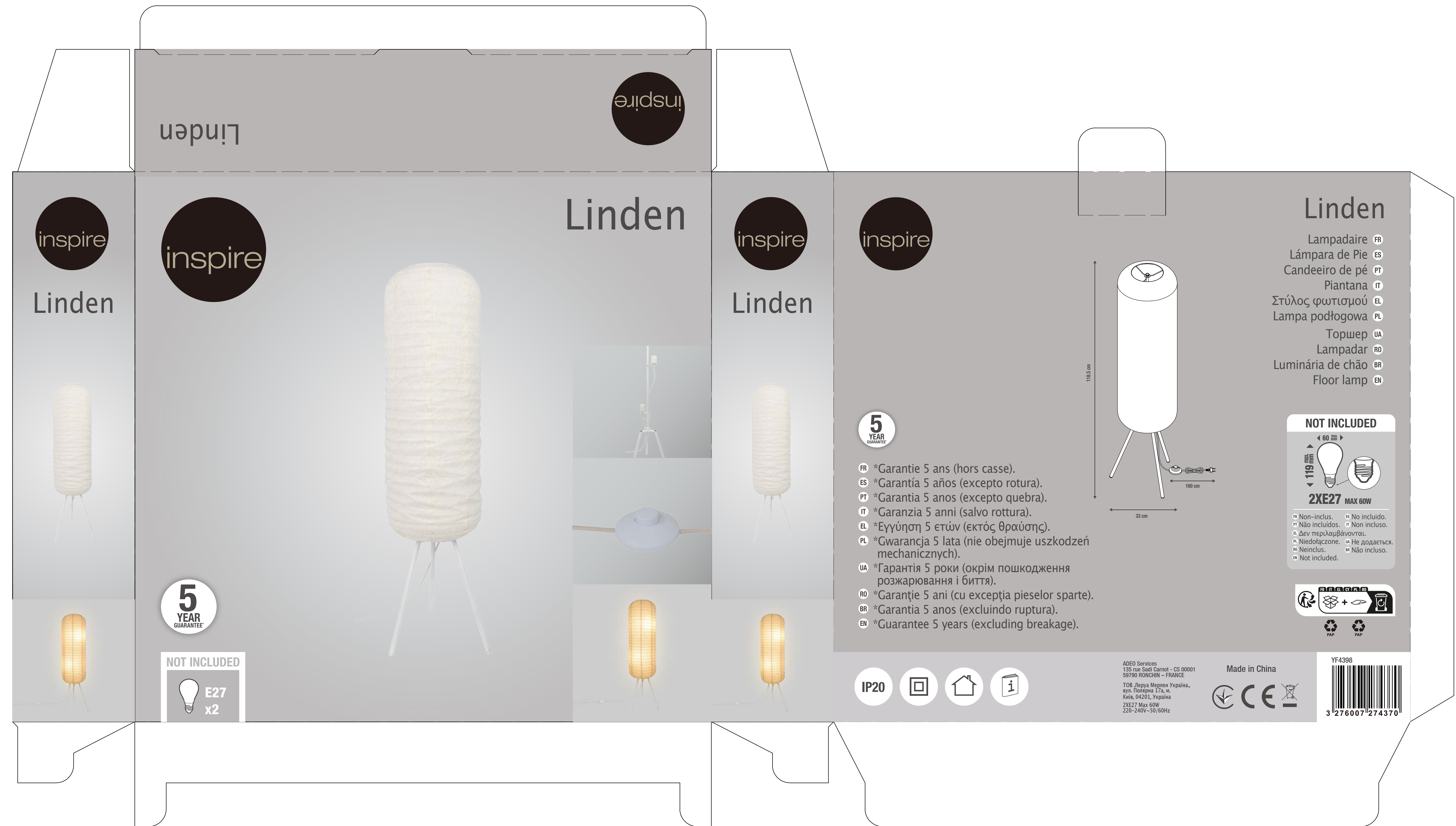
A18 YF4398彩盒刀模图 L330*W70*H315mm
