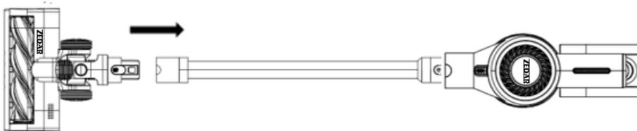
Befestigen Sie die elektrische Bürste am Aluminiumrohr, bis sie in der richtigen Position einrastet.
