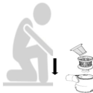
7. Setzen Sie den Staubbehälter wieder in das Hauptgerät ein. Drehen Sie den Staubbehälter, bis er einrastet.
