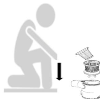
7. Plaats de stofbak terug in het hoofdapparaat. Draai de stofbak totdat deze vastklikt.
