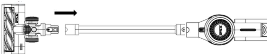
Fixez la brosse électrique au tube en aluminium jusqu'à ce qu'elle s'enclenche dans la bonne position.
