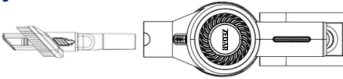
Befestigen Sie die Fugendüse an der Haupteinheit, bis sie in der richtigen Position einrastet.
