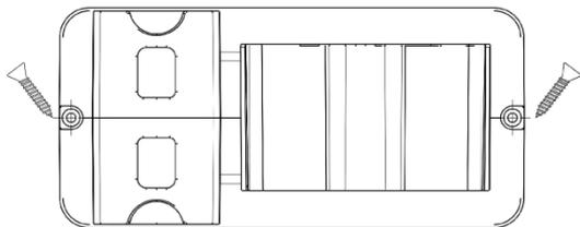
2. Appuyez doucement sur l'appareil dans le support jusqu'à ce qu'il s'enclenche.
