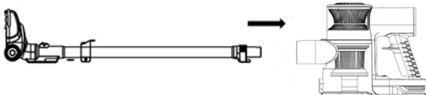
Fixez le tube au port de connexion de l'appareil principal.
