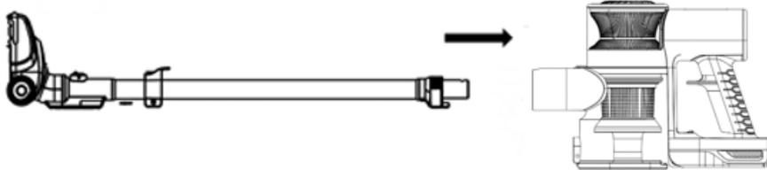
Befestigen Sie den Schlauch an der Anschlussöffnung des Hauptgeräts. Wenn der Schlauch entfernt werden muss, halten Sie das Hauptgerät fest und drücken Sie die Entriegelungstaste. Danach kann der Schlauch entfernt werden.
