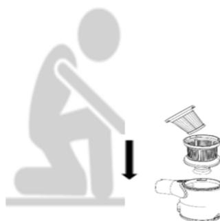
7. Remplacez le bac à poussière dans l'unité principale. Faites pivoter le bac à poussière jusqu'à ce qu'il s'enclenche.
