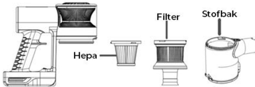
5. Vervang het HEPA filter elke 3 maand. De filters zijn te bestellen via onderstaande QR.
