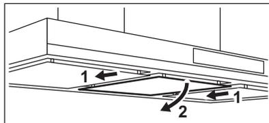
2. Kallutage filtri esiosa kergelt allapoole, seejärel tõmmake.
