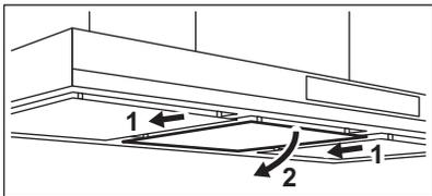
2. Kallista suodattimen etuosaa hiukan alaspäin ja vedä sen jälkeen.
