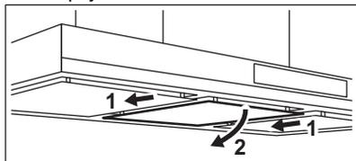
2. Incline ligeramente la parte delantera del filtro hacia abajo y tire de él.
