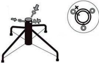
4. Drehen Sie die Ringschrauben [1] in die dafür vorgesehenen Gewindelöcher am Standfuß [C].
