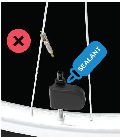
**DE:** Fülle das Reifendichtmittel nicht durch das Sensorventil, ohne den Sensor und die Ventileinheit zu entfernen. **EN:** Do not fill the tire sealant through the sensor valve, without removing the sensor and valve assembly. **ESP:** No verter el sellador de neumáticos a través de la válvula del sensor, sin haber quitado el conjunto del sensor y la válvula. **FR:** Ne pas injecter le produit d'étanchéité par la valve du capteur sans retirer l'ensemble capteur et valve.
