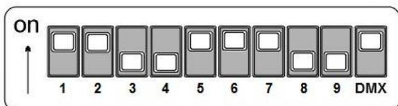
Mettez l'interrupteur DIP 10 sur ON pour activer l'adressage ; avec les 9 autres interrupteurs, réglez l'adresse voulue.
