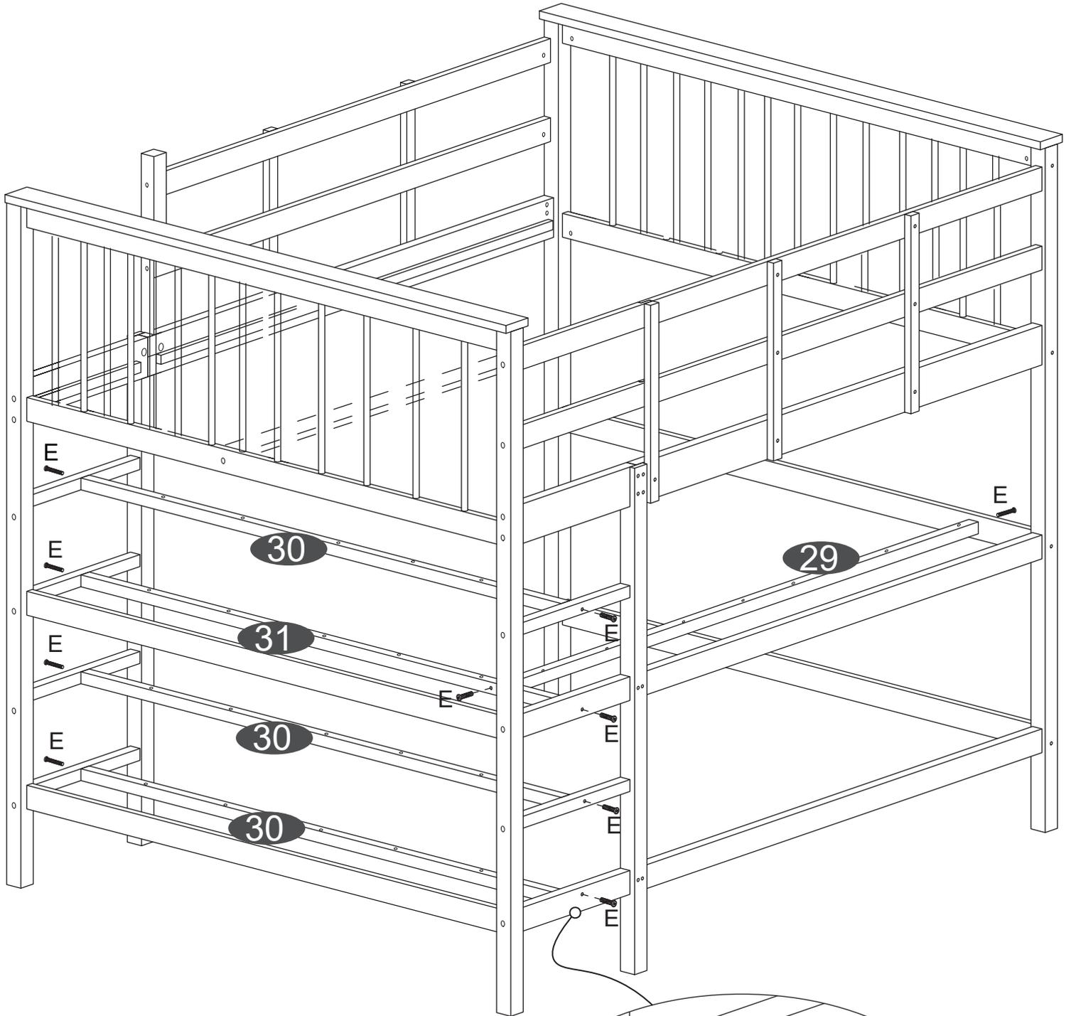
Beim Einbau der Teile 29, 30, 31 befinden sich die kleinen Löcher oben und die großen Löcher unten
