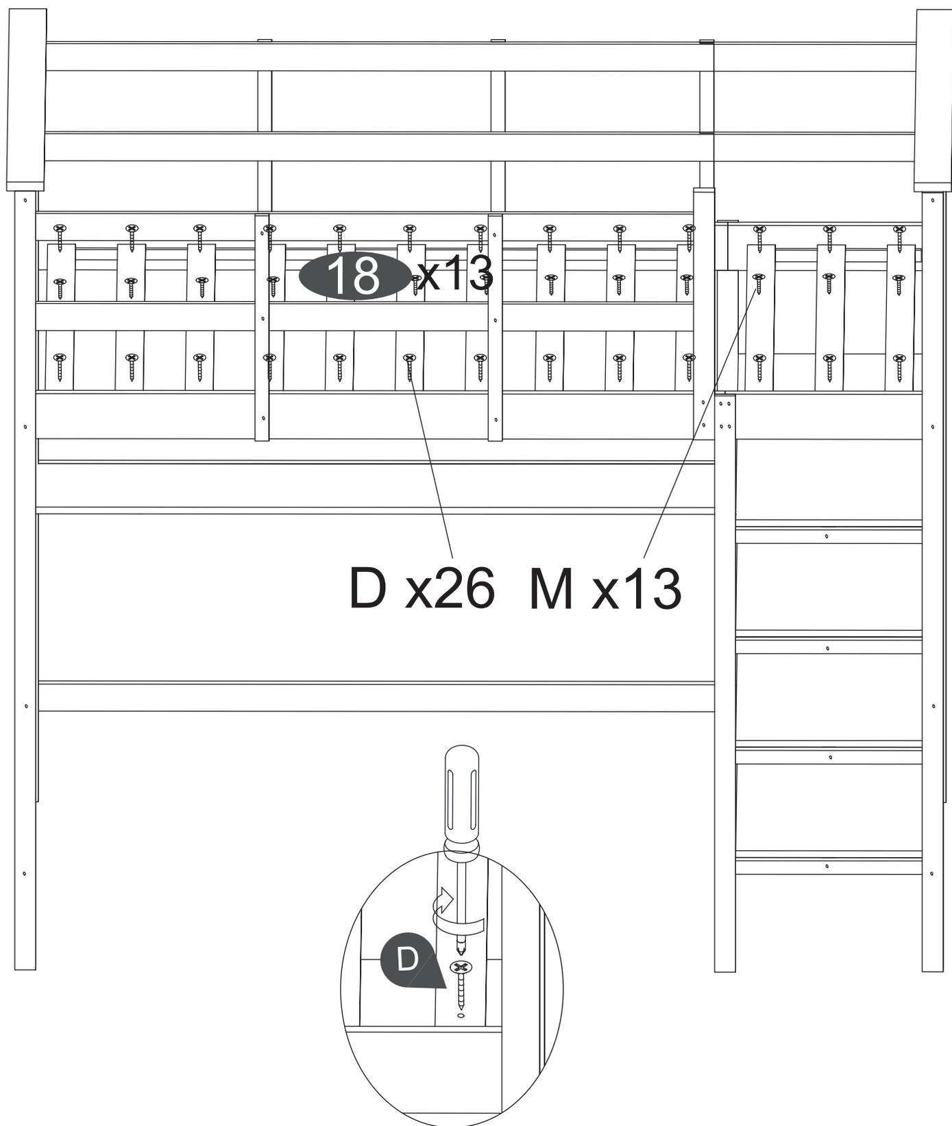
Bitte verwenden Sie die Schraube D für die Montage auf beiden Seiten und M für die Montage in der Mitte
