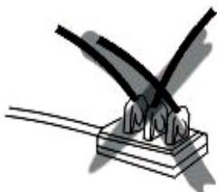
De wisselstroom moet uit een goed bedraad stopcontact komen. Steek de stekker volledig in het stopcontact. Als dit niet het geval is, kan het abnormaal heet worden. Gebruik geen stopcontact met elektrische verlichting. Sluit nooit meerdere stekkers aan op hetzelfde stopcontact.
