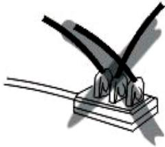
L'alimentation en courant alternatif doit provenir d'une prise de courant correctement câblée. Insérer complètement la fiche dans la prise. Si ce n'est pas le cas, il risque de devenir anormalement chaud. Ne pas utiliser de prise de courant. Ne jamais brancher plusieurs fiches sur la même prise.
