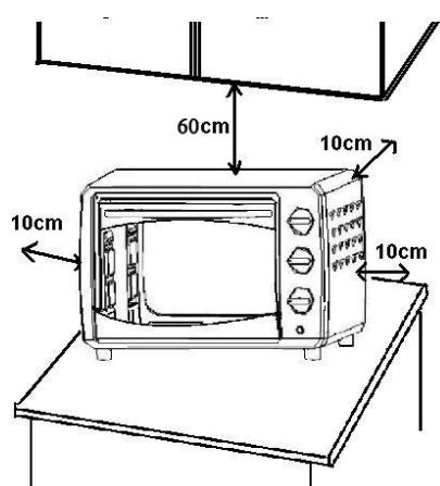
Si le four est placé trop près d'un mur, celui-ci sera brûlé ou taché. Veillez à ce que le rideau, etc. ne soit pas en contact avec le corps. Ne placez rien entre le fond de la carrosserie et la surface sur laquelle elle est posée, un objet ainsi placé pourrait être brûlé.
