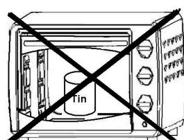
Les aliments en bouteille ou en boîte ne peuvent pas être chauffés directement, car la bouteille ou la boîte pourrait se briser et ébouillanter la personne.
