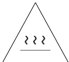
Let op! De temperatuur van het toegankelijke oppervlak kan hoog zijn als het apparaat in werking is.
