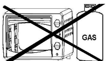
Ne placez pas l'appareil à proximité d'un brûleur à gaz ou d'une autre source de température élevée et ne dirigez pas un ventilateur électrique, etc. vers l'appareil pendant son **UTILISATION**. Cela pourrait empêcher un contrôle correct de la température.
