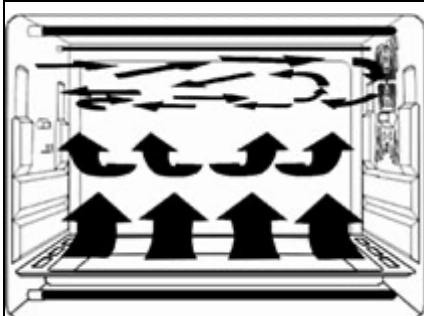
Destacado con una función especial de convección, fuerte y absoluto flujo de aire cílico haciendo el calentamiento más completo. Sabor original se puede mantener.
