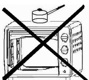
Ne posez rien sur le four pendant son utilisation, la chaleur pourrait provoquer des déformations, des fissures, etc.
