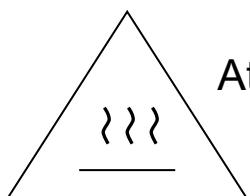
Attenzione: La temperatura della superficie accessibile può essere elevata quando l'apparecchio è in funzione.
