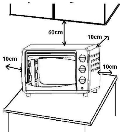
Als de oven te dicht bij een muur staat, zal de muur worden verbrand of bevuild. Zorg ervoor dat het gordijn enz. niet in dichtbij komt met de oven. Plaats niets tussen de bodem van de oven en het oppervlak waarop deze staat; een aldus geplaatst voorwerp zou kunnen verbranden.
