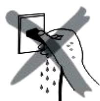
Ne mouillez pas le cordon d'alimentation et ne manipulez pas l'appareil avec des mains mouillées. Débranchez toujours le cordon après utilisation ou chaque fois que l'appareil est laissé sans surveillance un dysfonctionnement se produit lorsque la fiche est insérée dans la prise peut provoquer un incendie.
