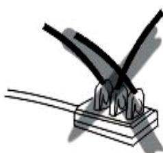
La alimentación de CA debe tomarse de una toma de corriente debidamente cableada. Inserte completamente el enchufe en la toma. De lo contrario, podría calentarse anormalmente. No
