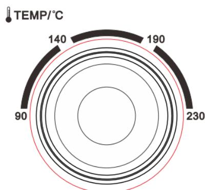
Ajuste el "Control de temperatura" girando en el sentido de las agujas del reloj para seleccionar la temperatura adecuada según los platos que vaya a cocinar. (Control de temperatura de 90°C a 230°C).
