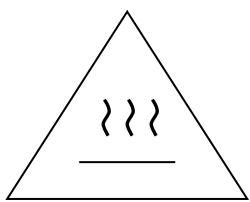
Precaución: La temperatura de la superficie accesible puede ser elevada cuando el aparato está en funcionamiento.
