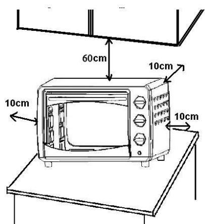
Si el horno se coloca demasiado cerca de una pared, ésta se quemará o manchará. Asegúrese de que la cortina, etc. no estén en contacto con la carrocería. No coloque nada entre la parte inferior del cuerpo y la superficie sobre la que está colocado, un objeto así colocado podría quemarse
