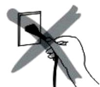
Al desenchufar el cable, sujete siempre el propio enchufe. Nunca tire del cable. Podría romper los alambres del interior del cable
