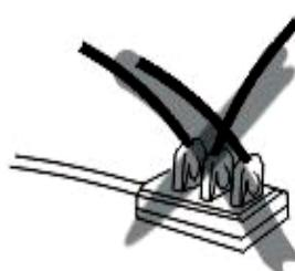
L'alimentazione CA deve essere prelevata da una presa di corrente correttamente cablata. Inserire completamente la spina nella presa. In caso contrario, potrebbe surriscaldarsi in modo anomalo. Non utilizzare una presa di corrente. Non collegare mai più spine alla stessa presa
