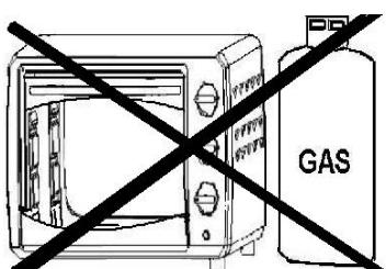
Nie ustawać urządzenia w pobliżu palnika gazowego lub innego źródła wysokiej temperatury, ani nie kierować na urządzenie wentylatora elektrycznego itp. podczas użytkowania. Może to uniemożliwić prawidłową kontrolę temperatury.
