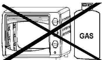
No coloque la unidad cerca de un quemador de gas u otra fuente de alta temperatura ni dirija un ventilador eléctrico, etc., hacia la unidad durante su uso. De lo contrario, podría impedir el control correcto de la temperatura
