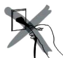
Podczas odłączania przewodu należy zawsze chwytać za samą wtyczkę. Nigdy nie należy ciągnąć za przewód. W ten sposób można uszkodzić przewody wewnętrz przewodu.
