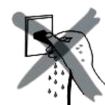
Non bagnare il cavo di alimentazione e non maneggiare l'apparecchio con le mani bagnate. Staccare sempre la spina dopo l'uso o ogni volta che l'apparecchio deve essere lasciato incustodito un malfunzionamento mentre la spina è inserita nella presa di corrente potrebbe causare un incendio
