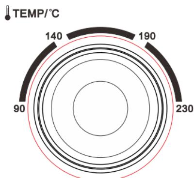
Réglez la "Commande de température" en tournant dans le sens des aiguilles d'une montre pour sélectionner la température appropriée en fonction des plats que vous allez cuisiner. (Commande de température allant de 90°C à 230°C).
