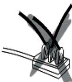
Zasilanie prądem zmiennym musi być pobierane z prawidłowo podłączonego gniazdka. Należy całkowicie włożyć wtyczkę do gniazda. W przeciwnym razie może się ona nadmiernie nagrzać. Nie należy używać gniazdka z oświetleniem elektrycznym. Nigdy nie podłączaj kilku wtyczek do tego samego gniazdka
