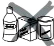
Was bij het schoonmaken de binnen- en buitenkant, de bakplaat, het rooster en de handgreep van de bakplaat met zacht katoen (of spons) met een neutraal schoonmaakmiddel. Daarna afspoelen met schoon water. Gebruik geen harde borstel of iets anders om te wassen om de binnenkant van de oven niet te beschadigen en om de bakplaat, het rooster en de handgreep van de bakplaat te beschermen.
