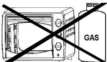
Non posizionare l'unità vicino a un bruciatore a gas o a un'altra fonte di alta temperatura, né dirigere un ventilatore elettrico, ecc. verso l'unità durante l'uso. Ciò potrebbe impedire il corretto controllo della temperatura.
