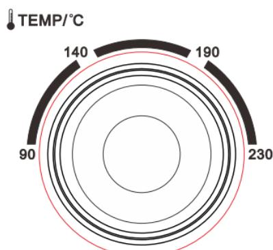
Ustaw "Regulację temperatury" obracając w prawo, aby wybrać odpowiednią temperaturę w zależności od potraw, które zamierzasz gotować (Regulacja temperatury w zakresie od 90 °C do 230 °C).
