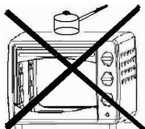
No coloque nada sobre el horno mientras lo utiliza, el calor podría provocar deformaciones, grietas, etc.
