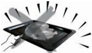
Per inserire e rimuovere il vassoio, utilizzare sempre la maniglia del vassoio. Il loro contatto può causare gravi ustioni.
