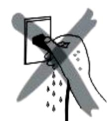
Nie wolno moczyć przewodu zasilającego ani obsługiwiać urządzenia mokrymi rękami. Zawsze odłączaj przewód po zakończeniu pracy lub zawsze, gdy urządzenie ma pozostać bez nadzoru nieprawidłowe działanie, gdy wtyczka jest włożona do gniazdka, może spowodować pożar.
