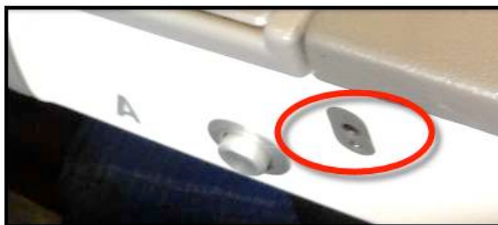
Figure 1.9 – Wtyczki wejściowe w fotelu samolotowym (podłokietnik)
