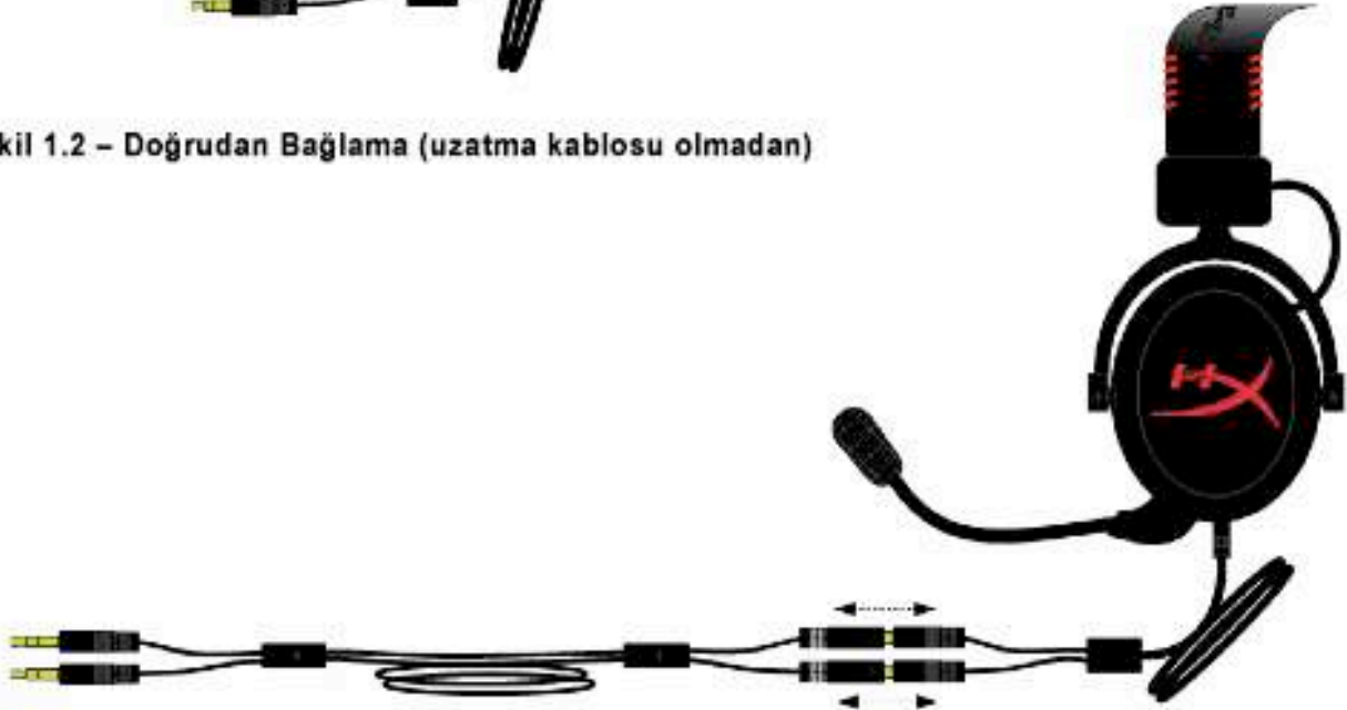
Şekil 1.3 – Doğrudan Bağlama (2 metre uzatma kablosu ile)
