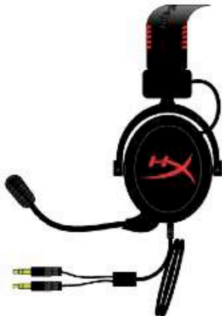
Figura 1.2 – Conexión directa (sin cable de extensión)
