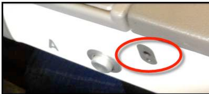
Figure 1.9 – Jacks d'entrée d'un accoudoir de siège d'avion
