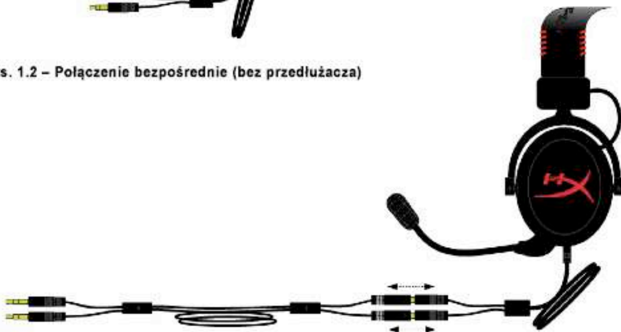
Rys. 1.3 – Połączenie bezpośrednie (z 2-metrowym przedłużaczem)
