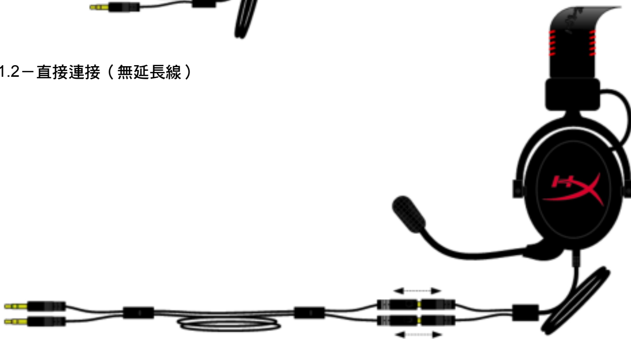
圖 1.3—直接連接 (含 2 公尺延長線)
