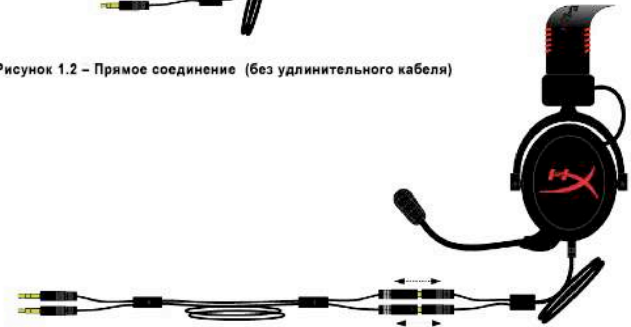
Рисунок 1.3 – Прямое соединение (с двухметровым удлинительным кабелем)
