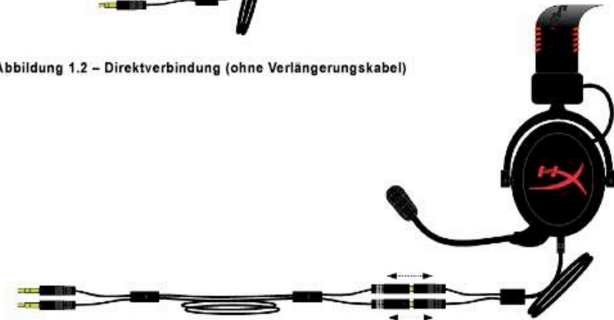
Abbildung 1.3 – Direktverbindung (mit 2-m-Verlängerungskabel)
