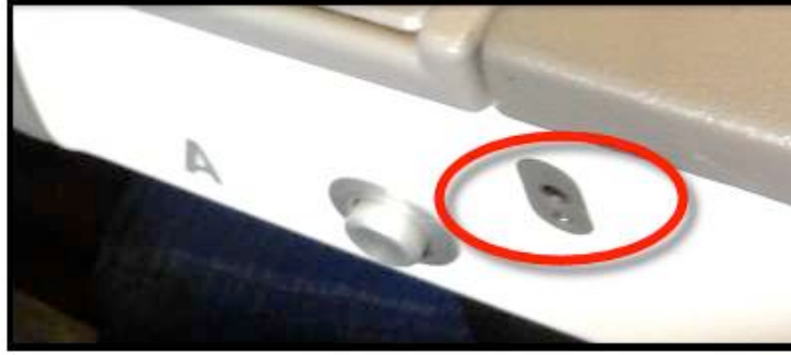
Şekil 1.9 – Uçak Koltuğundaki Giriş Jakları (Kol Dayanağı)
