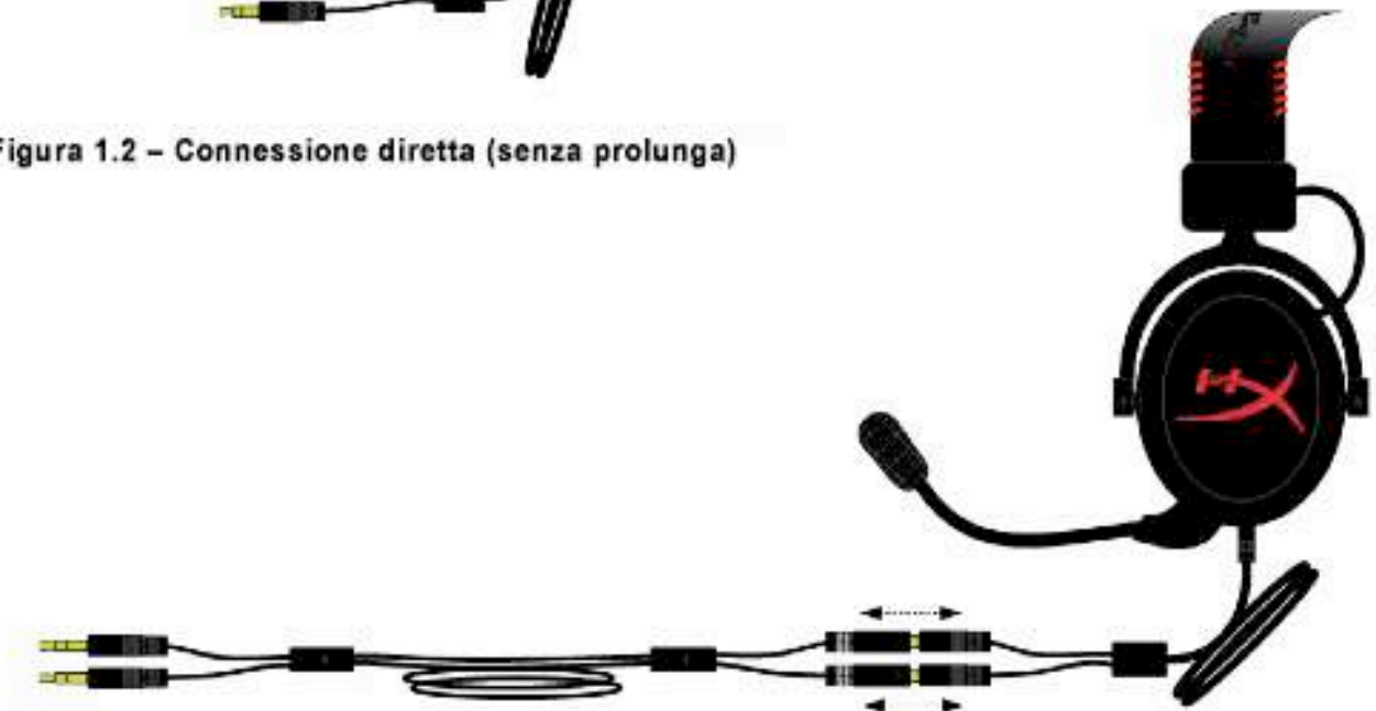
Figura 1.3 – Connessione diretta (con prolunga da 2 metri)
