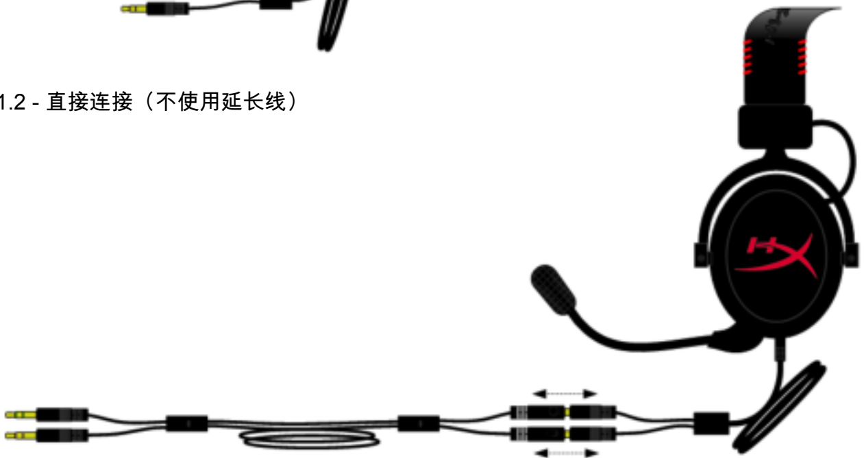
图 1.3 - 直接连接（使用 2 米延长线）
