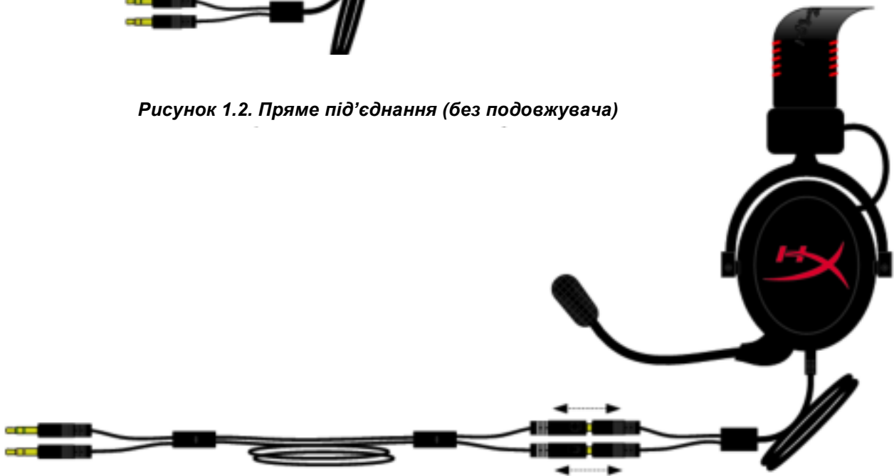
Рисунок 1.3. Пряме під'єднання (через кабель-подовжувач довжиною 2 метри).
