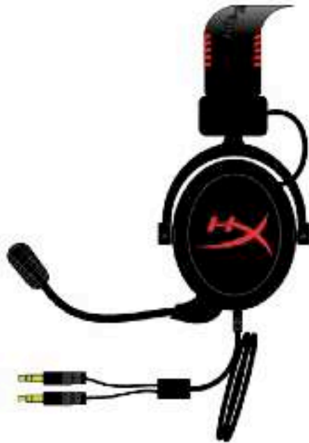
Figure 1.2 – Connexion directe (sans cordon d'extension)
