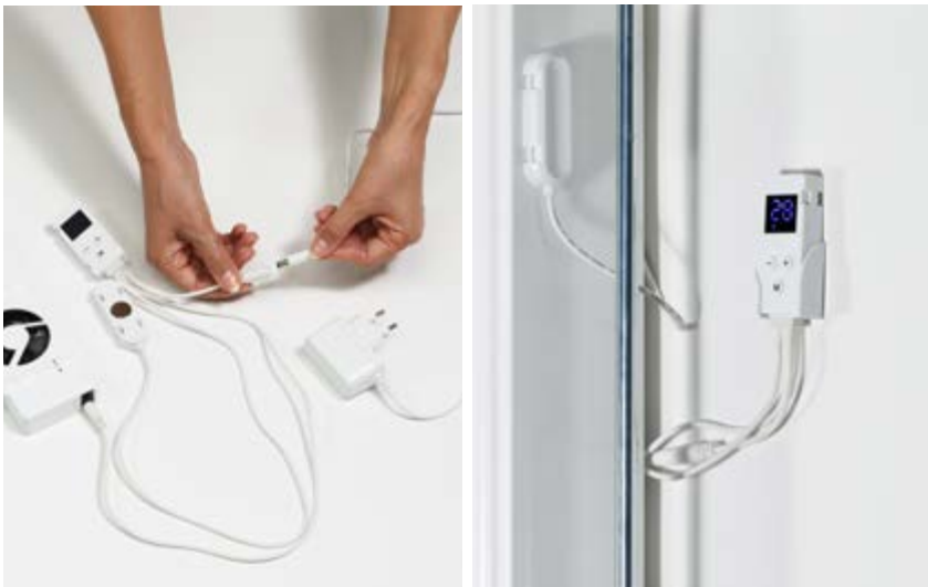
Abb. 11 – Anschließen des Control Sensor (F) und des Adapters (D).
