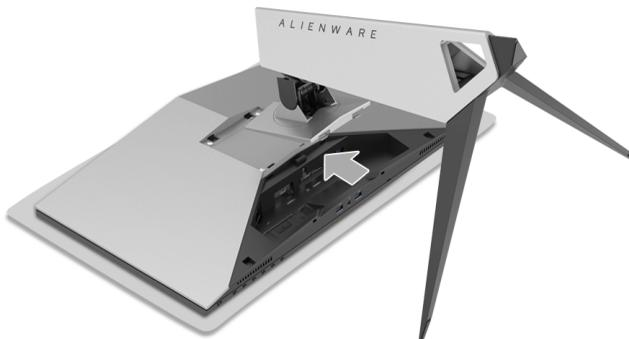
3. Verlegen und schließen Sie die benötigten Kabel wie in der Abbildung gezeigt an den Monitor an.
