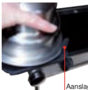
Opgelet: u dient de as nauwkeurig te volgen opdat u geen blokjes zou maken.
