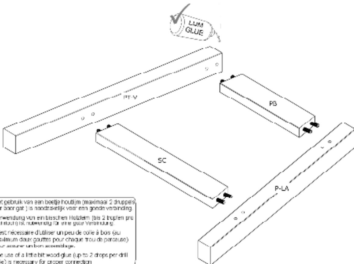
Het gebruik van een beetje houtlijm (maximaal 2 druppels per boorgat) is noodzakelijk voor een goede verbinding.
