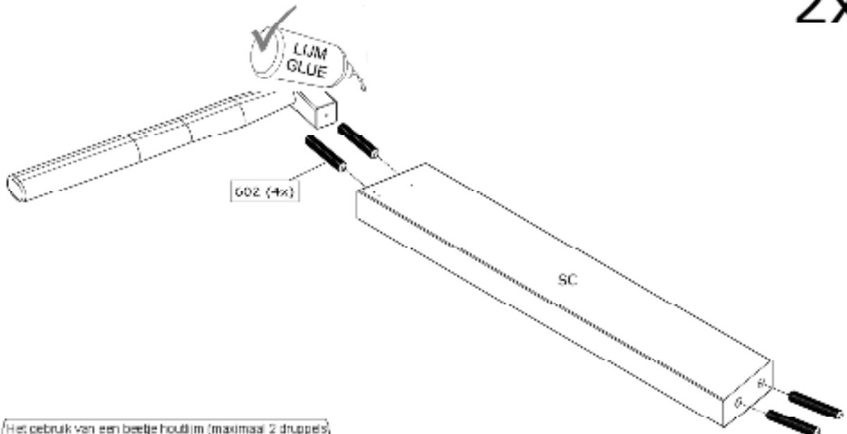
Het gebruik van een beetje houtlijm (maximaal 2 druppels per boorgat) is noodzakelijk voor een goede verbinding.
