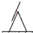
Figura 1 - Escalera combinada en posición de escalera de tijera con extensión en la parte superior
