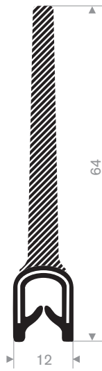
245.00.890 pvc + volrubber klembereik 1,5-4 mm
