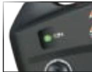
Wenn die Status-LED rot blinkt, sind eventuell die Batterien des Senders schwach, entladen oder nicht richtig installiert. Ersetzen Sie sie mit neuen oder frisch geladenen Batterien. Die Anzeigelampe zeigt nicht den Ladezustand der im Modell installierten Batterie an. Mehr Informationen über Sender, Statusanzeige und LED-Signale finden Sie auf Seite 30 im Abschnitt Fehlerbehebung.
