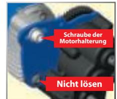
abzuschieben. Schieben Sie den Motor nach vorne, damit das Ritzel in das Zahnrad eingreift. Ziehen Sie die Schraube der Motorhalterung wieder an und entnehmen Sie den Papierstreifen. Der Papierstreifen sollte durch die Zahnräder bewegt werden können, ohne dass er klemmt.
