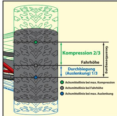
Wenn Sie die vorgespannten Scheiben des Stoßdämpfers in Richtung der Deckel bewegen, wird sich die Fahrhöhe des Fahrzeugs verringern und das Abfallen der Aufhängung wird sich vergrößern. Dadurch verringert sich der Schwerpunkt des Fahrzeugs, was das Handling verbessert. Sie verlieren aber an Bodenfreiheit.
