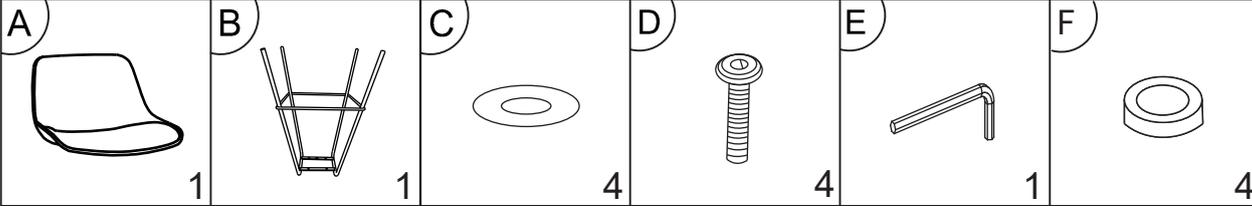
**Stap 1:** Bereid de montage voor. Verwijder het verpakkingsmateriaal en draai het zitvlak (A) om. Makkelijk is het om de zitting op een rand van de tafel te zetten.
