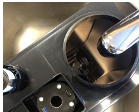
Pakiškite vandens bakelį po **čiaupu** ir pripildykite, laikydami už rankenos po vandens bakeliu. Pripildykite bakelį vandentiekio vandens (ar kitokio švaraus vandens, ne šiltesnio nei 40 °C), atgal uždékite dangtelį ir filtrą. Dar kartą apverskite vandens bakelį, kad jis būtų tinkama puse aukštyn. Įsitikinkite, kad dubuo švarus ir atsargiai įdékite vandens bakelį atgal į apatinę korpuso dalį.
