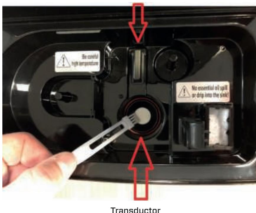
**Limpieza del transductor / elemento calentador PTC y de la cuenca de agua**
