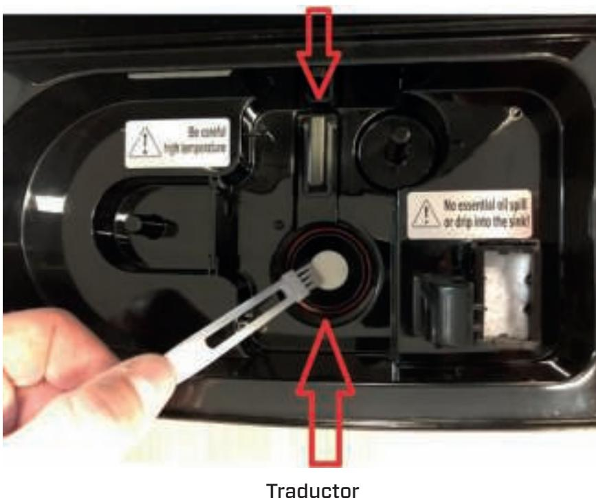
**Curățarea traductorului/elementului de încălzire PTC și a rezervorului de apă**
