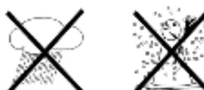
**⚠** Bei längerem Transport bei Kälte und dem anschließenden Wechsel in warme Räume nicht sofort einschalten; Temperaturausgleich abwarten.
