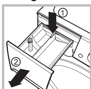
Verwijder het laadje door op het hendeltje (1) te drukken en het naar voren te trekken (2) (zie afbeelding). Was het onder stromend water. Dit moet u regelmatig doen.
