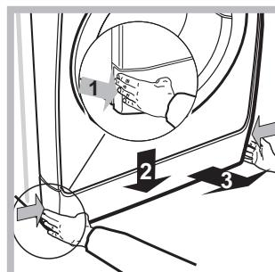
1. verwijder het afdekpaneel aan de voorzijde van de wasautomaat door er op het midden op te drukken. Duw beide zijkanten naar beneden toe en verwijder het paneel (zie afbeeldingen).
