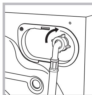
2. Das andere Ende des Schlauches an den oben rechts am Rückteil des Waschvollautomaten befindlichen Wasseranschluss anschließen (siehe Abbildung).
