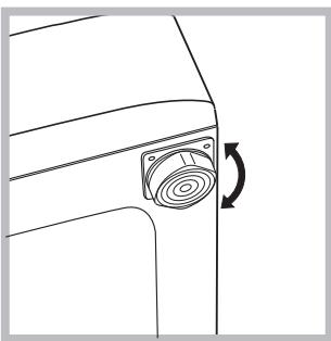
2. Sollte der Boden nicht perfekt eben sein, müssen die Unebenheiten durch An- bzw. Ausdrehen der vorderen Stellfüße ausgeglichen werden (siehe Abbildung), der auf der Arbeitsfläche zu ermittelnde Neigungsgrad darf 2°
