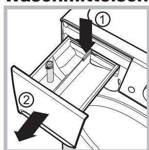
Drücken Sie auf den Arretierhebel (1) und ziehen Sie die Waschmittelschublade nach vorne hin heraus (2) (siehe Abbildung). Spülen Sie sie regelmäßig unter fließendem Wasser gründlich aus.
