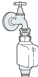
tuyau d'alimentation de sécurité
