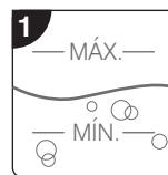
Utilizando um recipiente, encha o depósito de água com água morna. Assegure-se de que o nível da água está entre as marcas de nível da água de máximo e mínimo, indicadas na parede interior.
