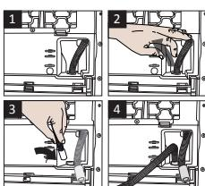
1-2 Trek de slang met de hand achter de droger om deze los te koppelen vanwaar hij is aangesloten. Gebruik geen gereedschappen om de slang te verwijderen.
