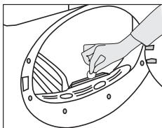
Votre sèche-linge est équipé de capteurs de séchage qui détectent si le linge est sec ou non. Pour nettoyer les capteurs :
