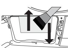
Les peluches collectées sur la surface du condenseur doivent être enlevées avec un chiffon humide ou en frottant la brosse placée sur le couvercle d'acheminement de l'air de haut en bas sur le condenseur. Veuillez ne pas nettoyer les ailettes du condenseur dans le sens droite-gauche pour éviter tout dommage. Vous pouvez également utiliser un aspirateur avec une brosse pour le nettoyage. Le nettoyage du condenseur n'est pas recommandé avec un aspirateur sans brosse.
