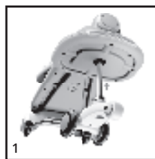
Figura 1: Instale el montaje de la rueda delantera (pieza 4) en el orificio de la carrocería (pieza 1).
