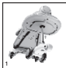
Abbildung 1: Die Vorderradbaugruppe (Teil 4) in das Loch der Karosserie (Teil 1) montieren.
