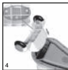
Abbildung 4: Die Hinterradbaugruppe (Teil 5) in die Karosserie (Teil 1) montieren und die Schnalle schließen, dann die drei Schrauben (Teil 3) in die Brücke des Hinterrads (Teil 5) montieren und festziehen.
