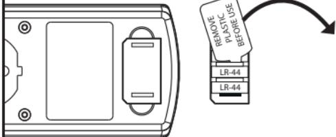
Return battery-compartment / Plaats batterijvak terug
