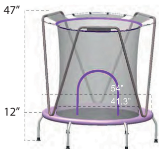
Figura 1. Dimensiones para trampolines pequeños de 54"
