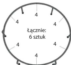
Układ ramy dla trampolin o średnicy 137 cm i 167 cm.
