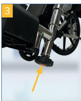
De zithoogte kan op 2 hoogten worden ingesteld. Verwijder de schroefbevestiging van de wielas en trek deze eruit. Bevestig het wiel op de gewenste hoogte en draai de schroefbevestiging weer vast. Verzekert u ervan dat de wielas stevig is aangehaald (**afb. 8**)!
