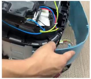
9. 拆卸底部螺丝,将五金内衬和隔热层组件分离。
