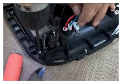
15. 使用钻头将电热管两端的铆钉松开,取出电热管
