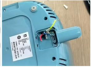
6. 撬开脚垫,取出底座上的螺丝,即可取出底座。
