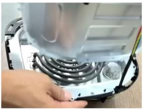
10. 拆卸内衬边缘处的螺丝,将五金内衬和底座分离。
