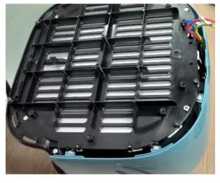
7. 拔下接线端子,并拆卸下壳的螺丝,取出下壳件。
