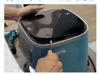
3. 使用十字螺丝刀将上壳的螺丝拆下,取出上壳件。
