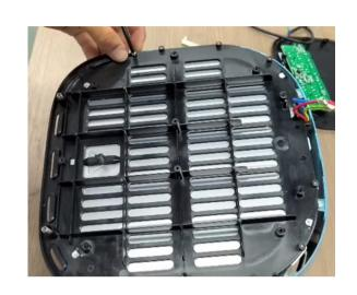
8. 拆卸隔热层边上的螺丝,取出炸篮外罩。
