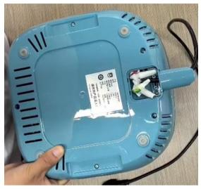
5. 使用尖嘴钳将连接线端子拆开,取出电源线。
