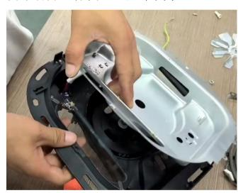
18. 同时压住3块照明灯的突起片,即可拆出照明灯
