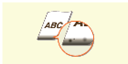
Vlekken aan de onderzijde van afdrukken
