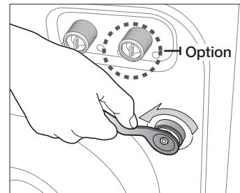
2. Halten Sie den Bolzen mit dem Schraubenschlüssel, und ziehen Sie ihn durch die breite Aussparung an der Öffnung. Dieser Vorgang muss für alle Transportsicherungen ausgeführt werden.
