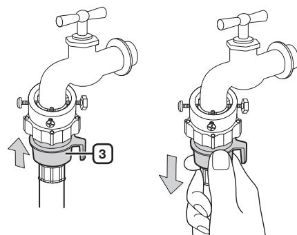
5. Raccordez l'autre extrémité du tuyau d'arrivée d'eau à la vanne d'alimentation en eau située à l'arrière du lave-linge. Vissez le tuyau à fond dans le sens des aiguilles d'une montre.
