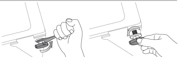
3. Wenn die Waschmaschine waagerecht steht, ziehen Sie die Sicherungsmutter mit dem mitgelieferten Werkzeug fest.
