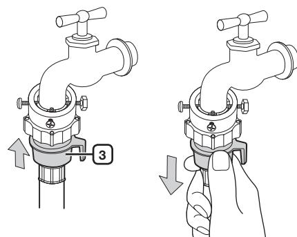
5. Verbinden Sie das andere Ende des Wasserzufuhrschaubes mit dem Wasserventil auf der Rückseite der Waschmaschine. Drehen Sie die Schrauben im Uhrzeigersinn fest.
