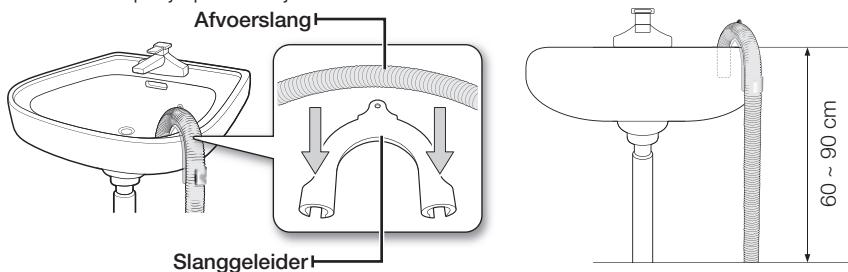
2. **In een aftakking van de gootsteenafvoer:** de aftakking moet hoger zijn dan de zwanenhals van de gootsteen, zodat het uiteinde van de slang zich ten minste 60 cm boven de grond bevindt.
