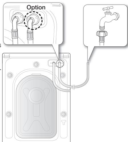
2. Schließen Sie ein Ende des Zuwasserschlauchs an die Waschmaschine und das andere Ende an den Wasserhahn an. Achten Sie darauf, dass der Zuwasserschlauch nicht gedeckt wird. Sollte der Schlauch zu kurz sein, verwenden Sie einen längeren Hochdruckschlauch.
