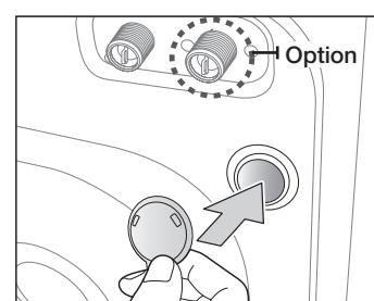
4. Bewahren Sie die Sicherungsbolzen an einem sicheren Ort auf, falls Sie die Waschmaschine in der Zukunft noch einmal transportieren müssen.
