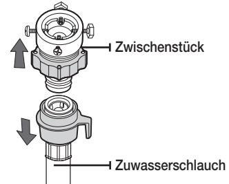
2. Verwenden Sie einen Kreuzschraubenzieher, um die vier Schrauben des Zwischenstücks zu lösen. Drehen Sie dann Teil (2) des Zwischenstücks in Pfeilrichtung, bis ein Abstand von 5 mm entstanden ist.
