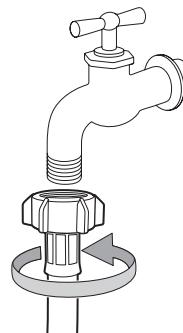
Utilisez un robinet standard pour l'arrivée d'eau. Si le robinet est à angle droit ou s'il est trop gros, retirez la bague d'écartement avant d'insérer le robinet dans l'adaptateur.
