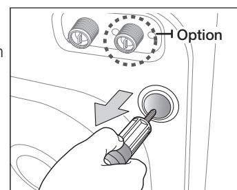
3. Verschließen Sie die Transportsicherungsöffnungen mit den mitgelieferten Kunststoffabdeckungen.
