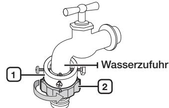
4. Schließen Sie den Wasserzufuhrschauch am Zwischenstück an. Wenn Sie Teil (3) loslassen, so wird der Schlauch automatisch mit dem Zwischenstück verbunden und ein Klicken ist zu hören.
