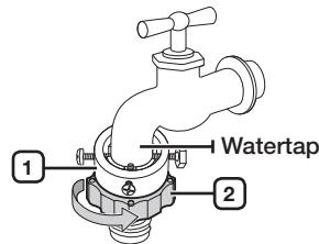
4. Sluit de watertoevoerslang aan op de adapter. Als u onderdeel (3) loslaat, wordt de slang automatisch verbonden met de adapter met een hoorbaar 'klik' geluid.
