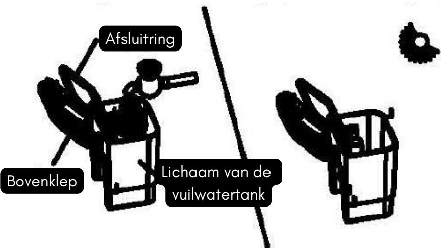
4. Reinig de tank, het bovendeksel en de afdichtring. Om de groei van bacteriën te voorkomen en om te voorkomen dat het apparaat gaat stinken, dient u de tank op tijd schoon te maken en deze na het schoonmaken te drogen.
