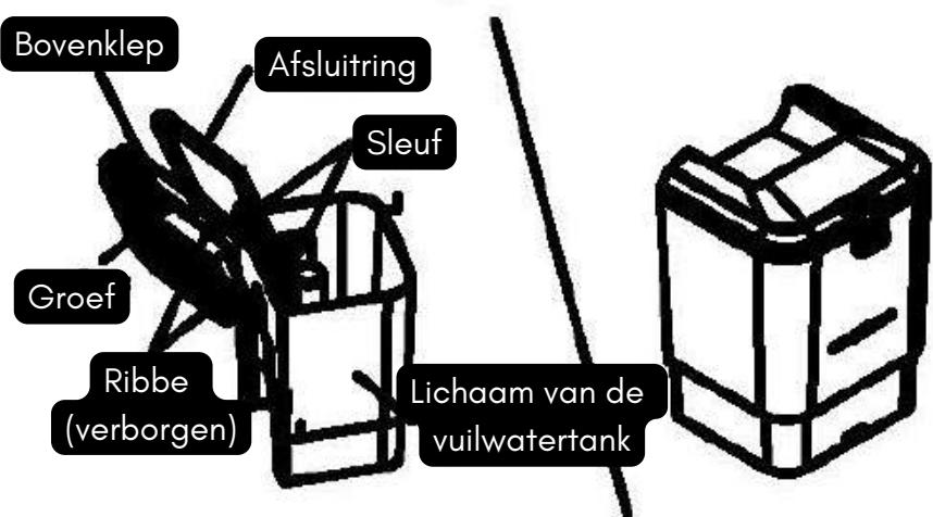
5. Steek de afsluitring in de groef in het bovendeksel; Steek de ribbe van de bovenklep in de gleuf van de watertank en draai de bovenklep.
