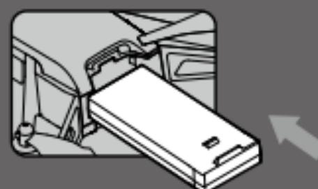
Para carregar a Bateria de Voo, conecte a porta Micro USB da aeronave a um adaptador USB (não fornecido) usando um padrão cabo micro USB.
