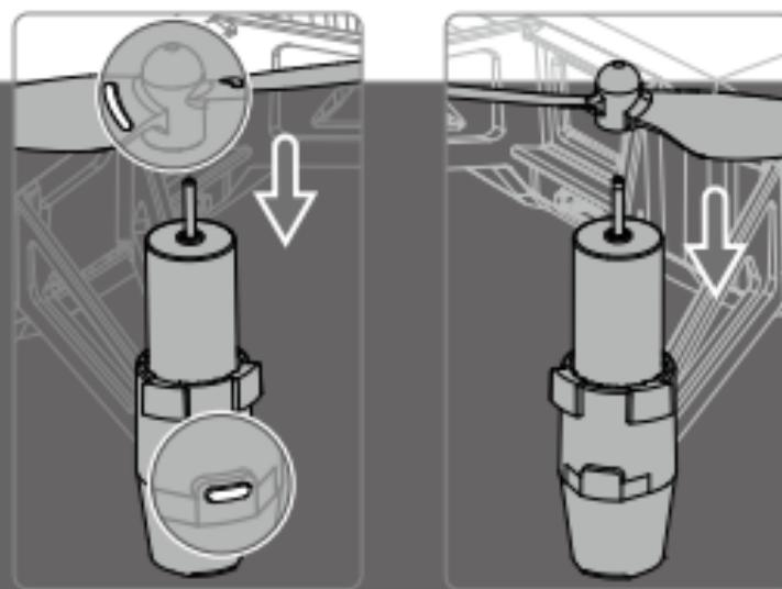
マーク付きのランディングギア上のモーターにマーク付きのプロペラを取り付けます。
