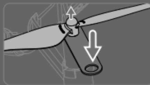
Détachez toujours les hélices en utilisant l'outil de retrait d'hélice. Ne retirez PAS les hélices à la main : vous pourriez gravement vous blesser ou endommager les moteurs.
