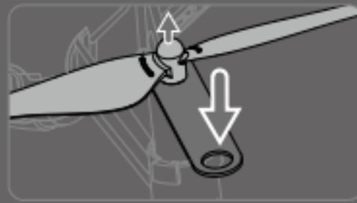
**⚠ Sempre desconecte as hélices usando a ferramenta de remoção da hélice. NÃO remova as hélices manualmente, ou você poderá ficar gravemente ferido, além de danificar os motores.**
