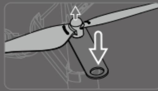
**⚠** 勿必使用拆槳工具拆卸螺旋槳。請勿用手直接拆下，否則將損壞馬達或割傷手指。
