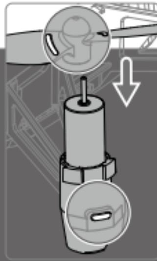
帶凸起標記的螺旋槳安裝於腳架帶凸起標記的馬達上
