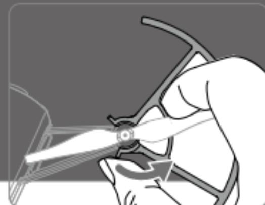
⚠ Üben Sie KEINE starke Krafteinwirkung aus, wenn Sie die Propellerschützer entfernen, da die Träger des Fluggeräts dadurch beschädigt und Sie verletzt werden können.
