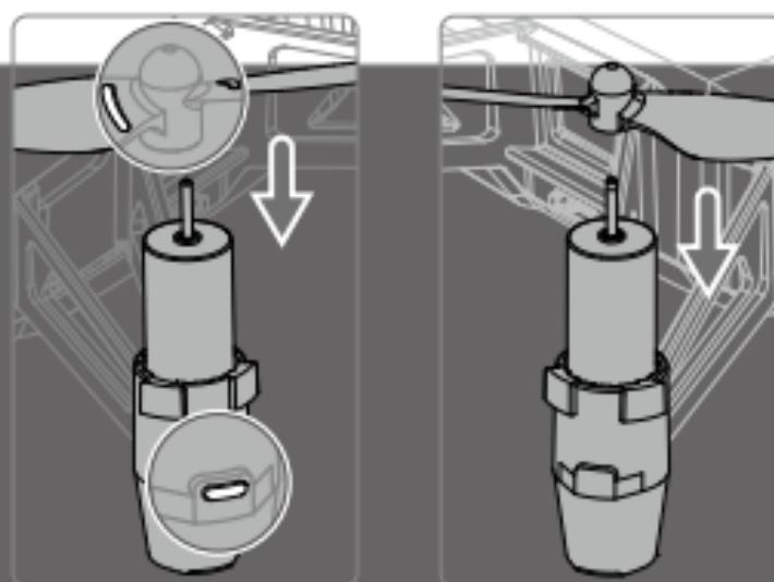
Montieren Sie die markierten Propeller an den Motoren mit dem markierten Landegestell.
