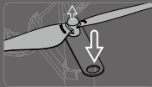
Remova sempre as hélices utilizando a ferramenta de remoção da hélice. NÃO remova as hélices manualmente, caso contrário, poderá sofrer ferimentos graves e danificar os motores.
