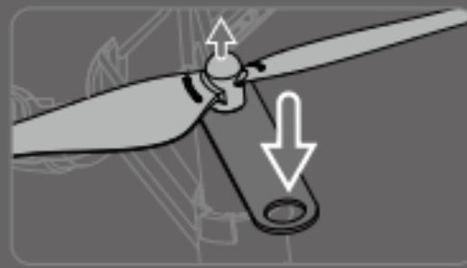
Verwijder de propellers altijd met behulp van het hulpmiddel voor het verwijderen van de propellers.
