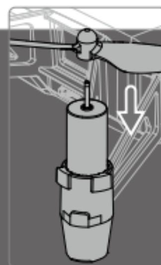
Coloque as hélices sem marcas nos motores cujos trens de aterragem não têm marcas.
