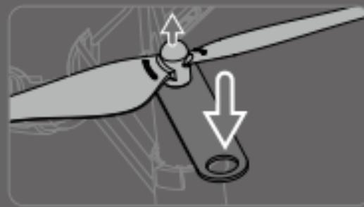
**⚠** Entfernen Sie die Propeller immer mit dem dafür vorgesehenen Demontagewerkzeug. Entfernen Sie die Propeller NICHT von Hand, da Sie ernsthaft verletzt und die Motoren beschädigt werden können.
