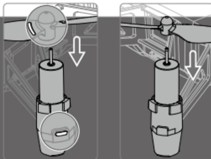
Установите пропеллеры с маркировкой на двигатели с промаркованными посадочными шасси.
