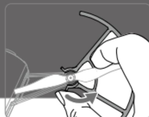
NO aplique demasiada fuerza cuando retire las protecciones para las hélices ya que, de hacerlo, podría dañar los brazos de la aeronave y usted podría resultar herido.
