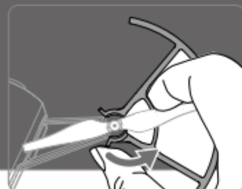
**⚠️** Gebruik GEEN grote kracht bij het verwijderen van de propellerafschermingen. Hierdoor kan de drone beschadigd raken en je kunt je bezeren.
