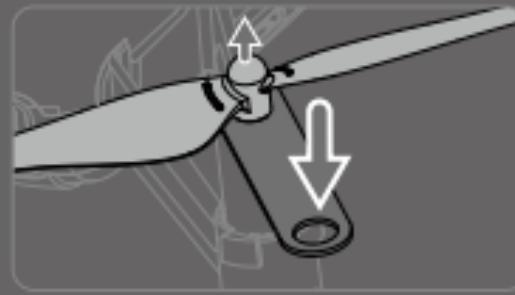
Retire siempre las hélices utilizando la herramienta
