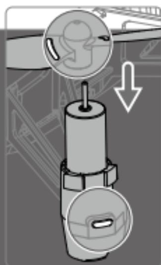
Coloque as hélices com marcas nos motores cujos trens de aterragem têm marcas.
