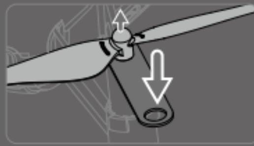
Снимайте пропеллеры только с помощью специального съемника. ЗАПРЕЩАЕТСЯ снимать пропеллеры вручную, т. к. это может привести к тяжелым травмам и повреждению двигателей.
