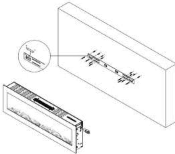
Vorsicht: Es wird empfohlen, die Halterung C mit Wandankern in die Wand zu schrauben, sollte die nicht möglich sein, verwenden Sie die beigefügten Plastikdübel und machen Sie sicher das die Halterung sehr gut befestigt ist.
