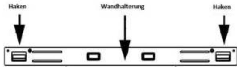
A. Halten Sie die Halterung an die Wand und markieren Sie die 8 Schrauben Löcher. Machen Sie sicher,dass die Halterung genau horizontal ist.
