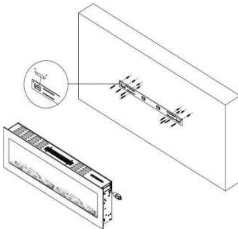
Opgelet: we raden aan beugel C met muurankers in de muur te schroeven. Indien dit niet mogelijk is, gebruik dan de meegeleverde plastic ankers en zorg ervoor dat de beugel zeer goed vastzit.
