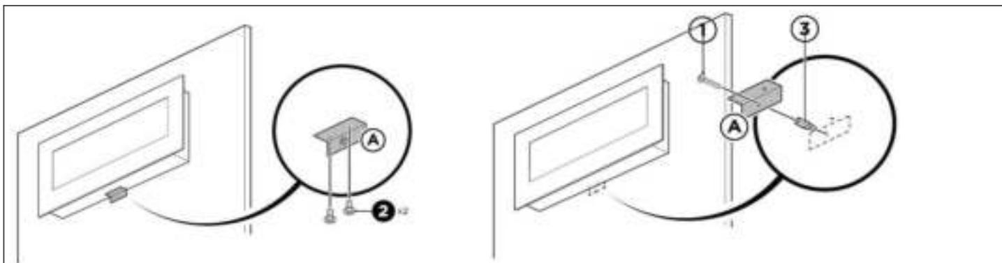
B. Wanneer de muurbeugel is geïnstalleerd, tilt u het toestel met twee personen op en steekt u de twee haken van de beugel in de daarvoor bestemde gaten aan de achterkant van de haard.
